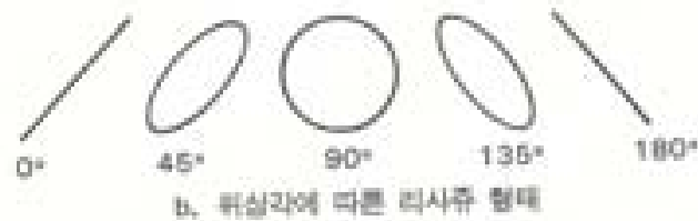
그림 2-11. 리사주 도형법에 의한 위상 측정
